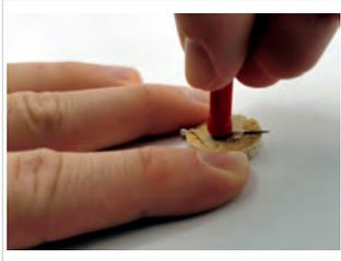
Streiche mit dem Nordpol des Magneten 30 mal vom Kopf zur Spitze der Nadel.
