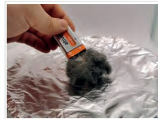
Halte die 9 Volt Batterie kurz mit beiden Polen an die Stahlwolle.
