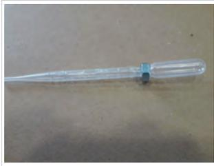
Schiebe die Mutter entlang des Pipettenhalses bis unter den Druckraum.
