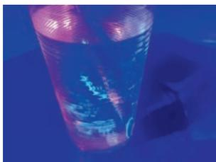
Beleuchte den Becher mit einer UV-Lampe oder einem UV-Nagelhärter. Man erkennt, dass sich UV-aktive Stoffe lösen.
