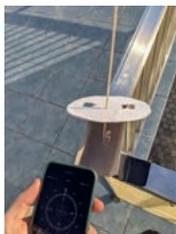
Richte deine Sonnenuhr mit einem Kompass/einer Handyapp nach Süden aus. Fixiere sie am besten noch mit Klebeband.
